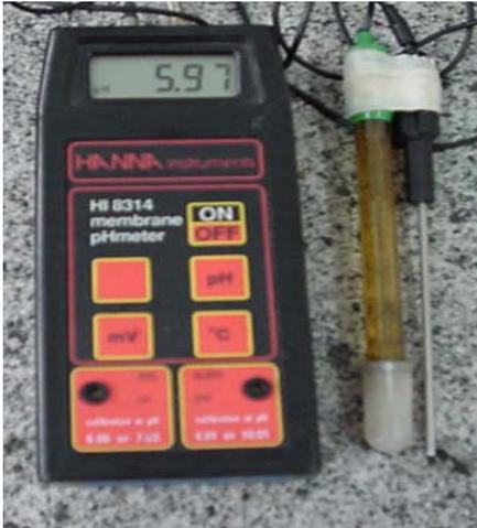
**Figura 9: Peagâmetro de membrana**
