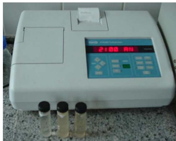
**Figura 14: Turbidímetro**
