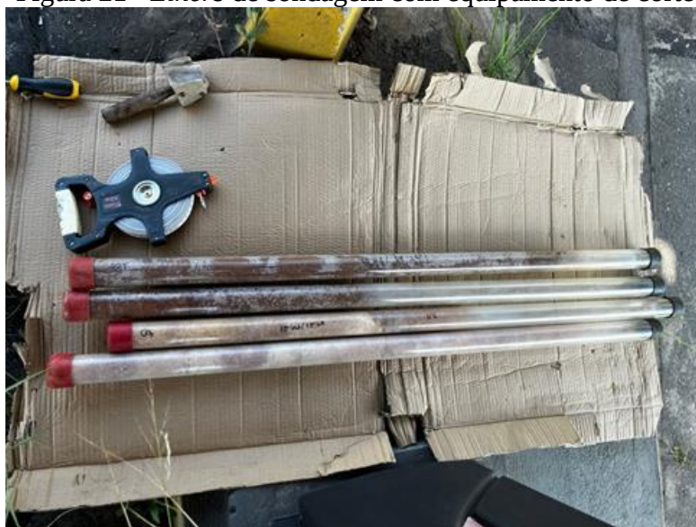
Figura 21 - Liners de sondagem com equipamento de corte
