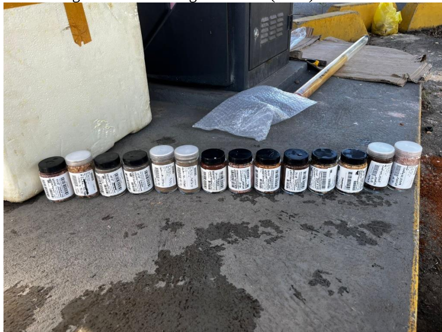
Figura 23 - Amostragem de solo (VOC) de uma UD
