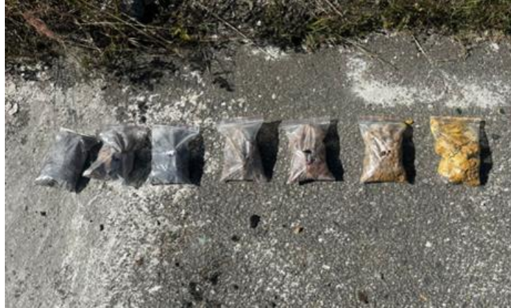
Figura 22 - Figura 20 - Amostragem de solo (SVOC) de uma UD
