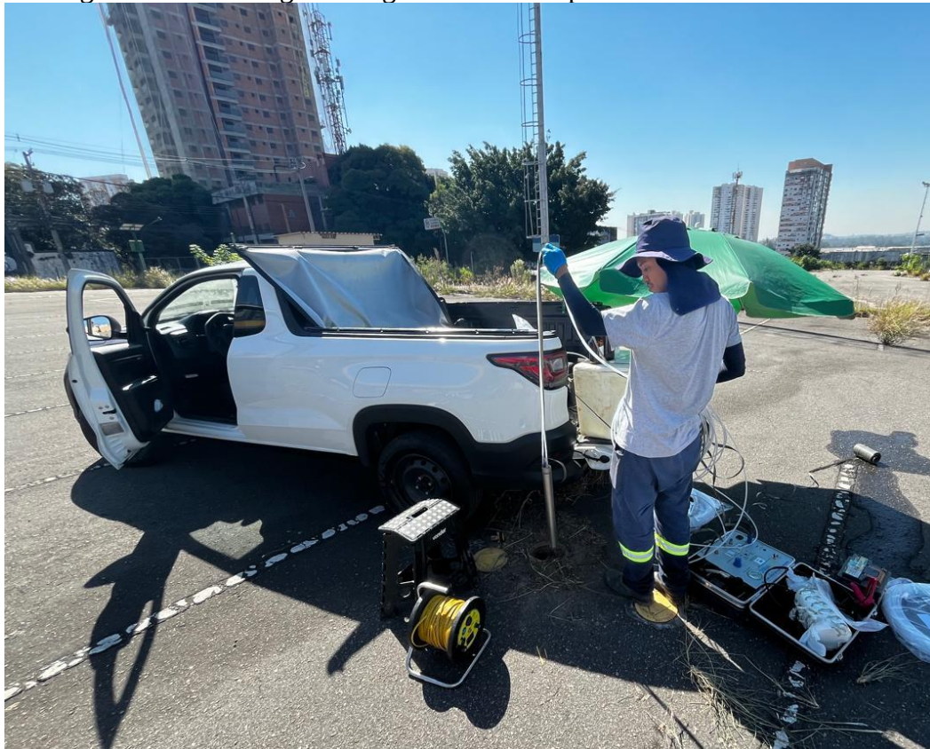
Figura 25 - amostragem de água subterrânea pelo método de baixa vazão
