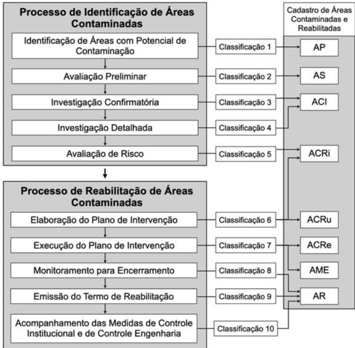
Figura 3 - Processo de Identificação e Reabilitação de Áreas Contaminadas
