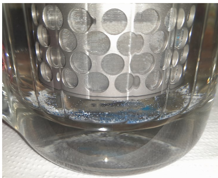
Figura 20. Saída dos catalisadores do RBR S2 SpinChem® a 200 rpm (após 1 hora de reação).
