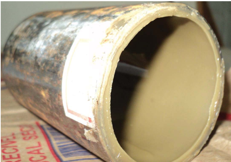
Figura 08 : Amostra 2, resina com rutilo
