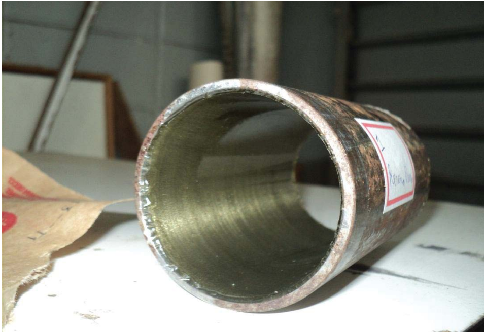
Figura 07: Amostra 1, resina pura
