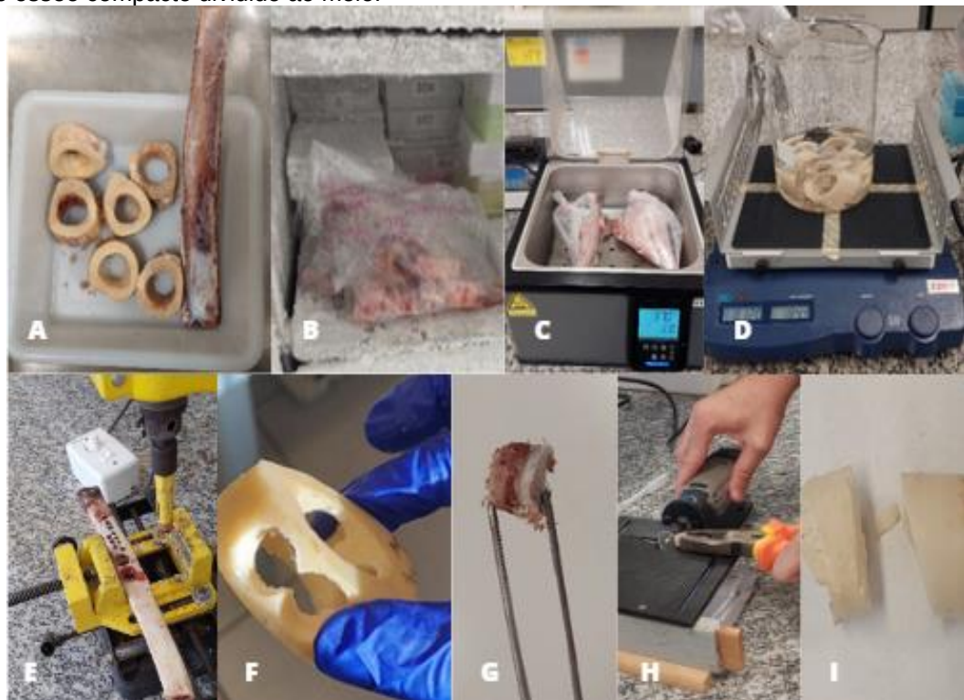
Figura 25- Etapas de criação dos scaffolds. A: Ossos bovinos após remoção da carne residual. B: Congelamento dos dois grupos. C: Descongelamento dos ossos. D: Tratamento químico com SDS no grupo híbrido. E: Perfuração óssea com furadeira. F: Osso compacto de fêmur bovino perfurado. G: Fragmento ósseo trabecular com córtex compacto. H: Divisão no meio de cada fragmento ósseo. I: Fragmento ósseo compacto dividido ao meio.
