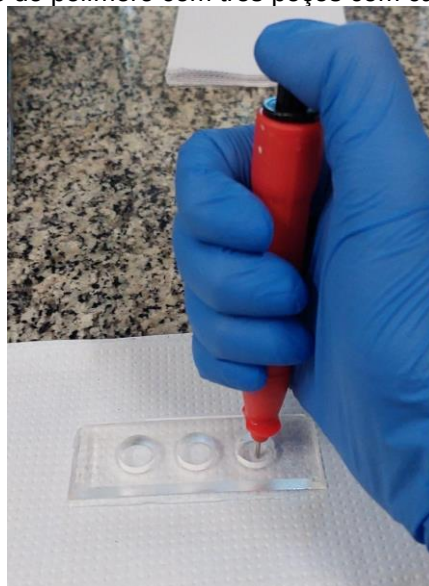
Figura 17- Perfuração do polímero com três poços com caneta perfuradora
