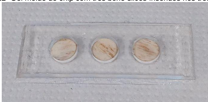
Figura 21- Gel molde do chip com três bone slices inseridos nos três poços
