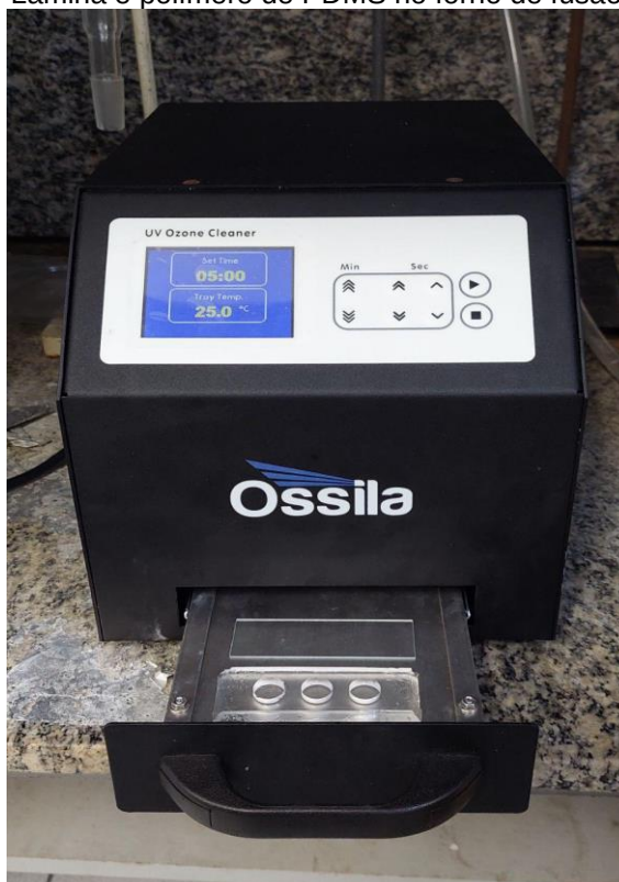
Figura 19- Lâmina e polímero de PDMS no forno de fusão de ozônio
