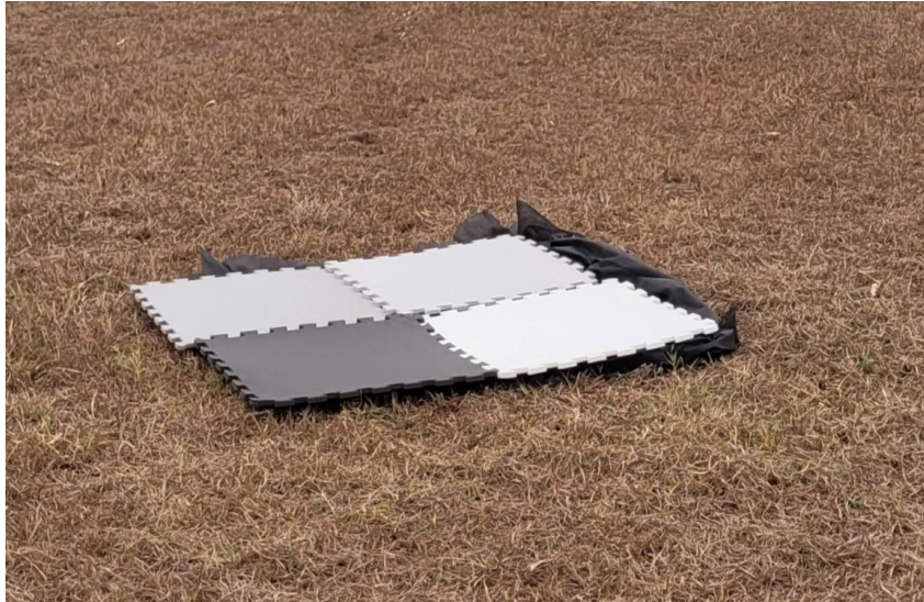
Figura 6. Alvos de calibração. Fonte: imagem própria.
