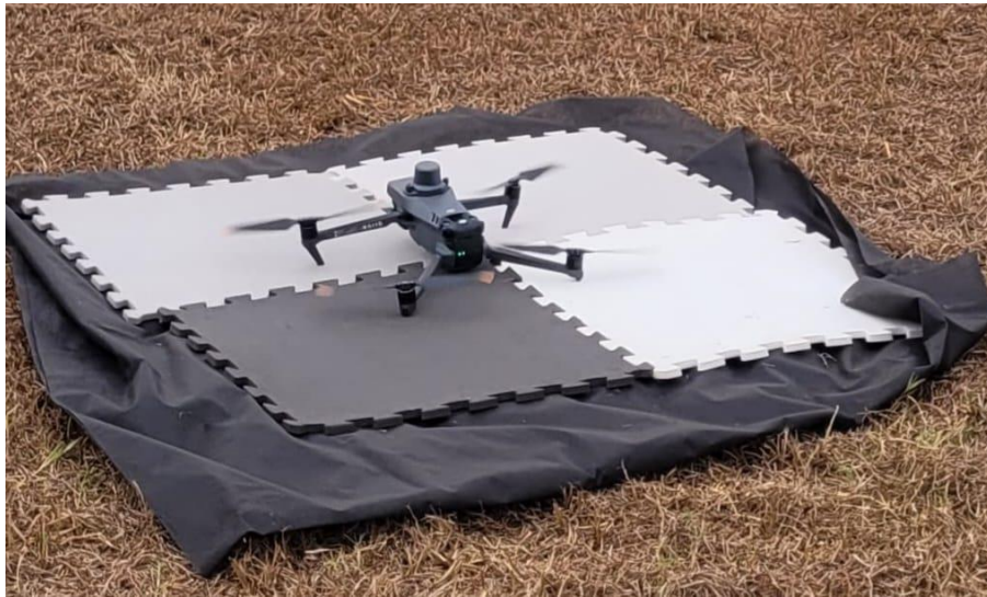
Figura 5. DJI Mavic 3 Multiespectral RTK para realização do voo para aquisição de imagens.
