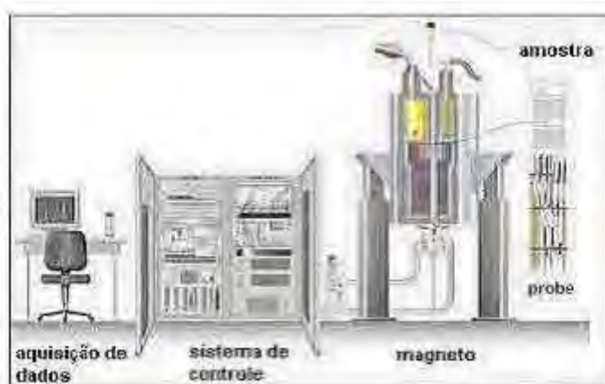
Figura 12: Desenho esquemático, contendo os componentes que fazem parte do equipamento de RMN.
