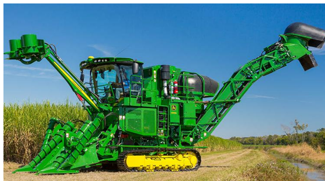
Figura 2 - Colhedora de cana 3520 John Deere
