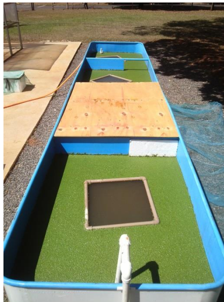
Figura 12- Quadro flutuante em PVC para isolar as lemnas e placa madeira fotoperíodo
