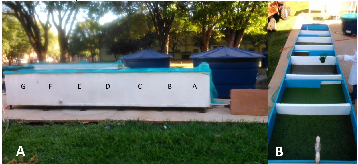
Figura 10- A) Sistema para o cultivo e polimento e B) Divisões no tanque e colheita da seção C
