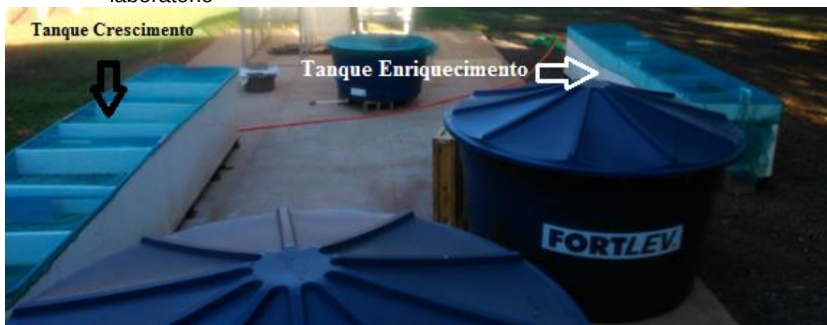
Figura 8- Configuração do sistema de tratamento montado em área externa do laboratório
