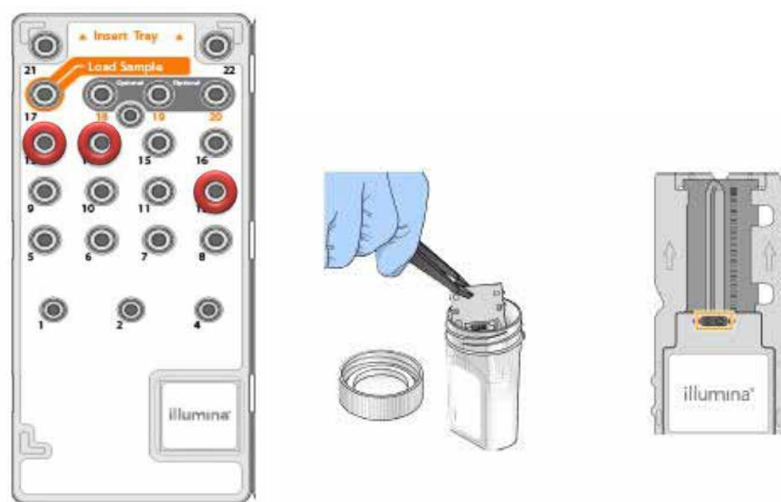
Figura 4 – Representação do cartucho de reagentes e flowcell (lâmina de fluxo) presentes no MiSeq Reagent NanoKit Illumina®. A figura sinaliza em vermelho as posições onde devem ser inseridos os primers foward (FowardMeta), reverse (RevMeta) e índex (IndexMeta) no cartucho de reagentes presente no kit MiSeq Reagent NanoKit Illumina®, conforme proposto por Caporaso et al. (2012). Ao lado, uma representação da flowcell , (lâmina de fluxo utilizada para adicionar as amostras que serão sequenciadas) que será inserida no equipamento MiSeq Illumina para que o sequenciamento aconteça.
