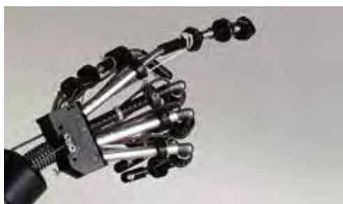
Figura 1.11 – Robô com músculos artificiais.
