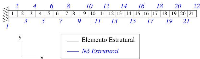
(a) elementos e nós da viga de aço
