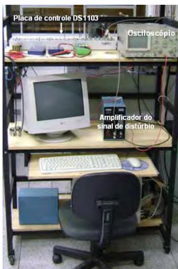
A2.4 – Sistema de aquisição utilizado na aplicação de controle.
