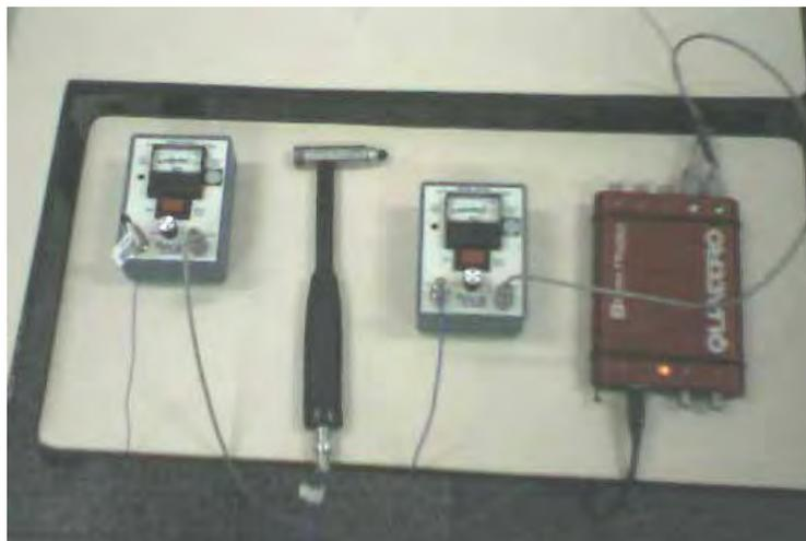
Figura 7.5 – Equipamentos utilizados na aquisição dos sinais.
