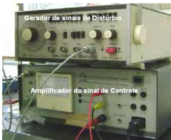
Figura A2.5 – Gerador de sinais de distúrbio e amplificador do sinal de controle.
