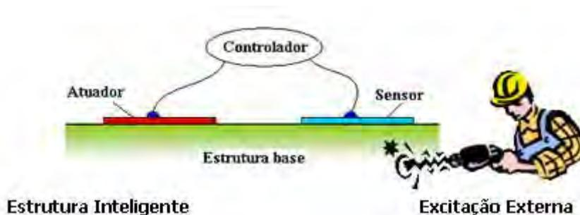
Figura 1.1 – Desenho esquemático de um sistema de controle ativo.
