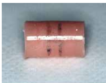
FIGURA 66 - Resina acrílica revestindo o fragmento. As marcas em grafite representam o local da secção de 2 mm.
