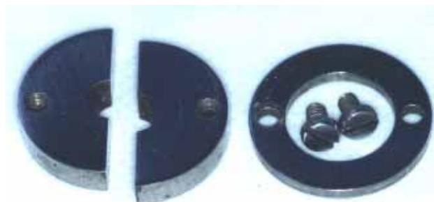
FIGURA 35 - Matriz metálica montada. FIGURA 36 - Matriz metálica desmontada. - duas hemipartes, anel e parafusos.
