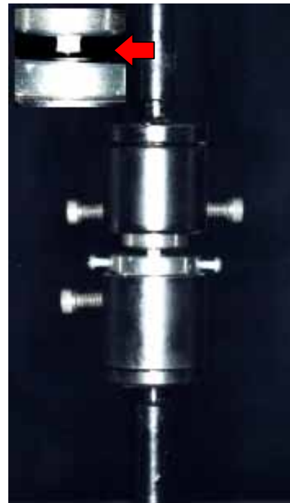
FIGURA 52 - Dispositivo instalado na MTS 810, pronto para a aplicação do teste. No detalhe superior esquerdo, a seta aponta a fratura.
