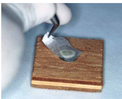
FIGURA 56 - Secagem com papel absorvente. Para as técnicas com substrato S1, exceto M5S1 e M6S1.
