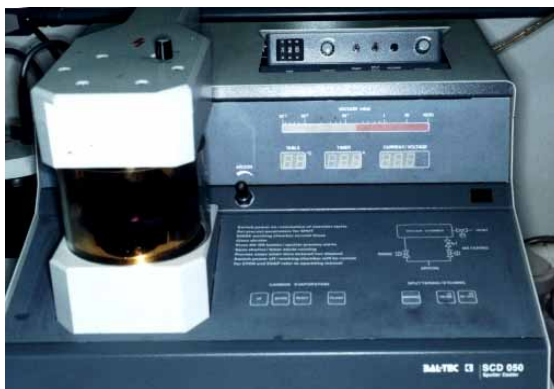
FIGURA 71 - Aparelho de metalização SCD 050 - Sputter Coater.
