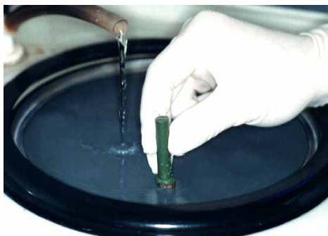
FIGURA 68 - Aplicação da seqüência de lixas em politriz circular mecânica.
