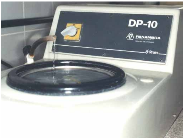
FIGURA 15 - Politriz Circular Mecânica Struers -para regularização e uniformização da smear layer.
