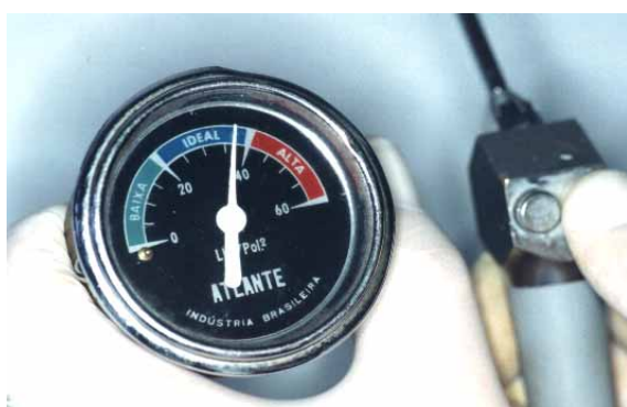
FIGURA 23 - Seringa tríplice utilizada para a desidratação tendo sua pressão aferida por manômetro.
