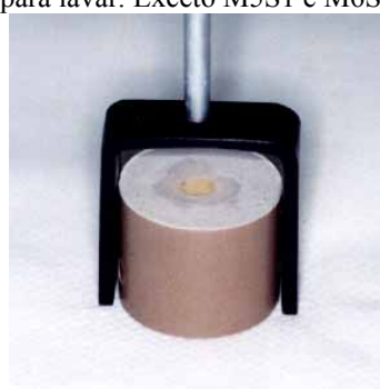
FIGURA 30 - Desidratação da dentina condiciona- da com ácido fosfórico 37%. O distanciador padro- nizava a distância de aplicação do ar em 10,0 mm. Somente as técnicas com substratos S2 e S3.
