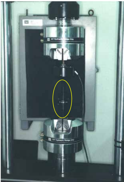
FIGURA 51 - MTS 810 - Material Test System e dispositivo de tração - detalhe em amarelo.
