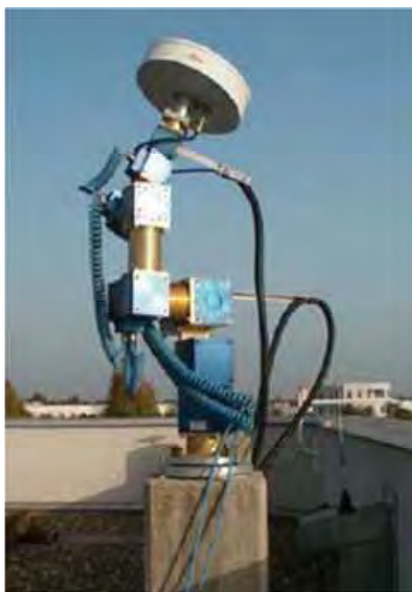
Figura 11 - Robô para calibração absoluta em campo de antenas GNSS Fonte: Zeimetz e Kuhlmann (2008).
