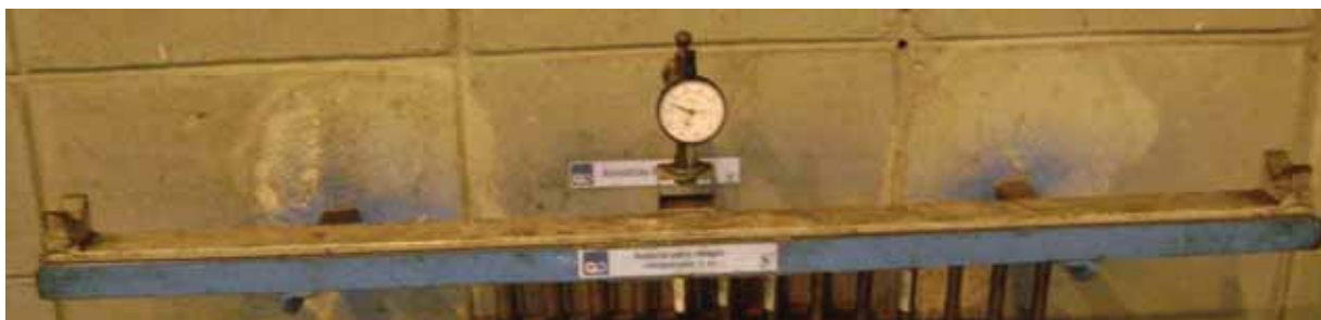
Figura 29: Ilustração do dispositivo para medir empeno com o relógio comparador
