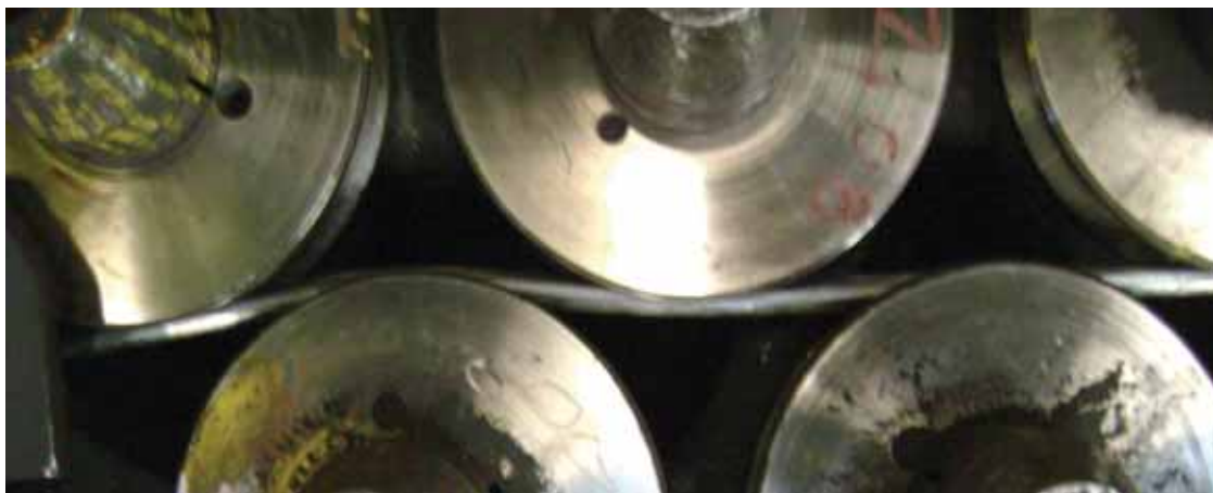
Figura 19: Deformação do material no pré endireitador
