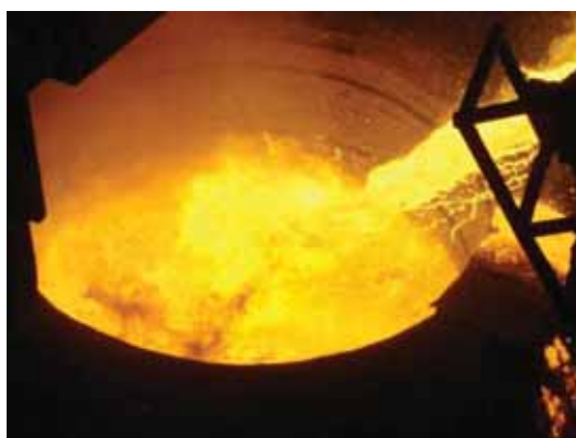
Figura 7: Vazamento do aço líquido para a panela.
