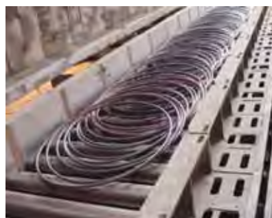
Figura 16: Stelmmor com a bobina em processo de resfriamento.
