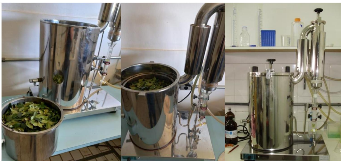
Figura 4. Fotos do destilador para extração dos óleos essenciais de C. langsdorffii e E. uniflora , marca Marconi modelo MA 480
