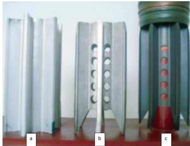
Figura 13 - Perfil na liga 7012, rabeira de míssil. Perfil: (a) Extrudado, (b) Usinado, (c) Componente Montado
