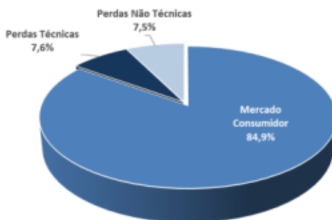
Figura 7: Perdas sobre a Energia Injetada
