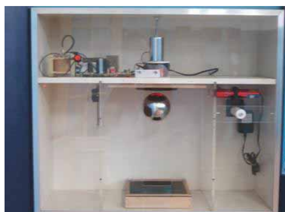
Foto 33 Experimento em que o visitante, ao acionar um dispositivo, faz uma bola levitar devido à força eletromagnética, CDCC 6
