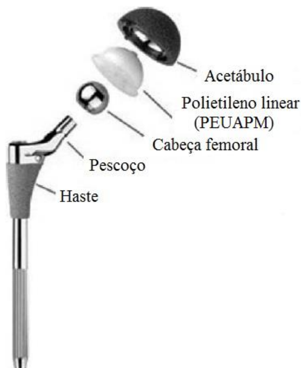
Figura 3 Componentes das próteses de quadril comerciais nos dias atuais.
