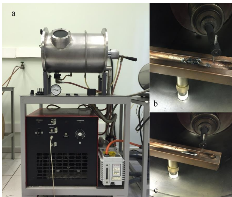
Figura 16 Forno a arco voltaico, (a) o equipamento completo, (b) detalhe dos materiais depositados no cadinho refrigerado, (c) botão obtido após a fusão
