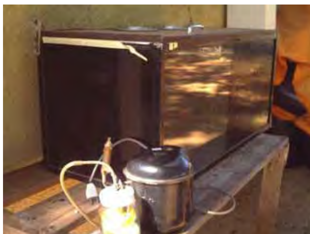
Fig. 04 – Vista externa da câmara de inalação utilizada para exposição dos animais à fumaça.
