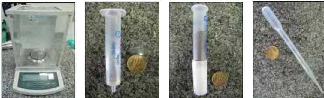
**Figura 4.** Balança analítica Shimadzu (AY220), cartucho plástico com pastilha porosa, cartucho com solo acoplado ao compartimento de coleta e picete de 3 ml, respectivamente.
