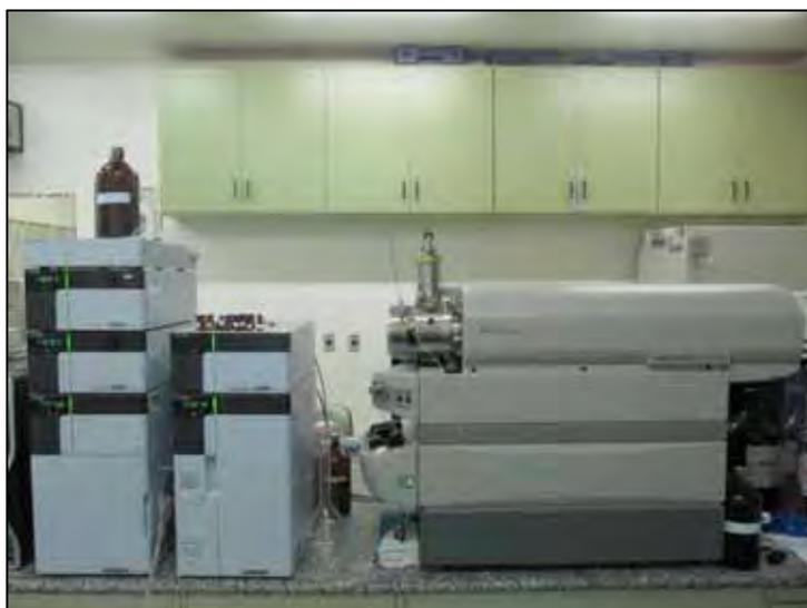
**Figura 6.** Cromatógrafo Líquido (Proeminence UFLC) acoplado ao espectrômetro de massas (3200 Q TRAP) LC-MS/MS. Botucatu/SP, 2012
