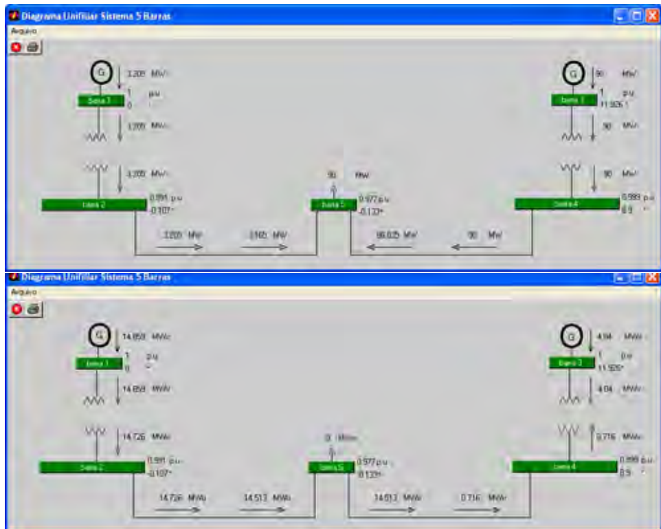
Figura 3.33 – Fluxos de potência ativo e reativo para o sistema de 5 barras obtidos pelo método de Newton-Raphson , considerando a barra 1 como referência angular.
