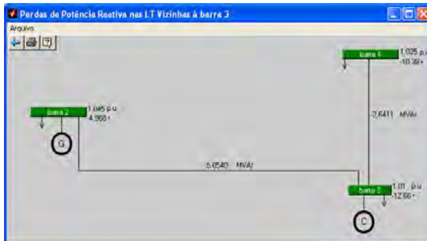
Figura 3.19 – As perdas de potência reativa nas linhas de transmissão pertencentes à vizinhança da barra 3.
