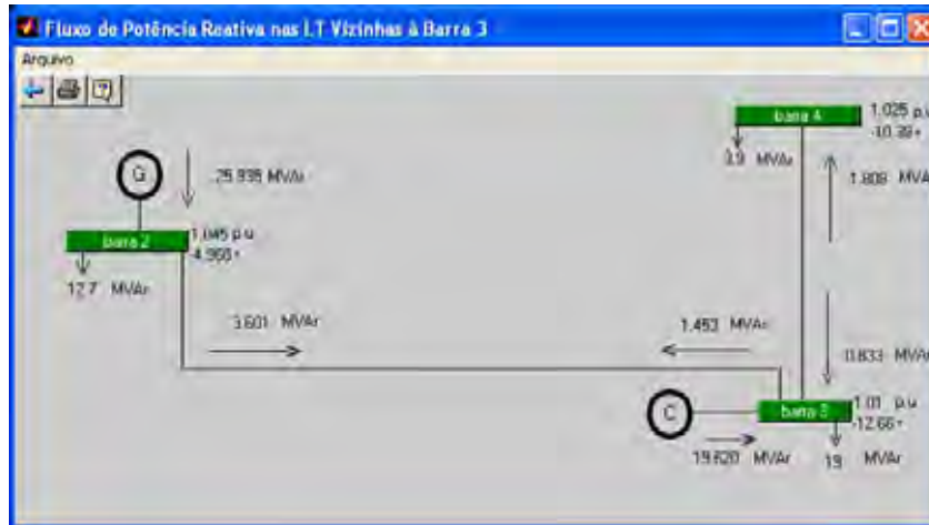
Figura 3.18 – Fluxo de potência reativa nas linhas de transmissão pertencentes à vizinhança da barra 3.
