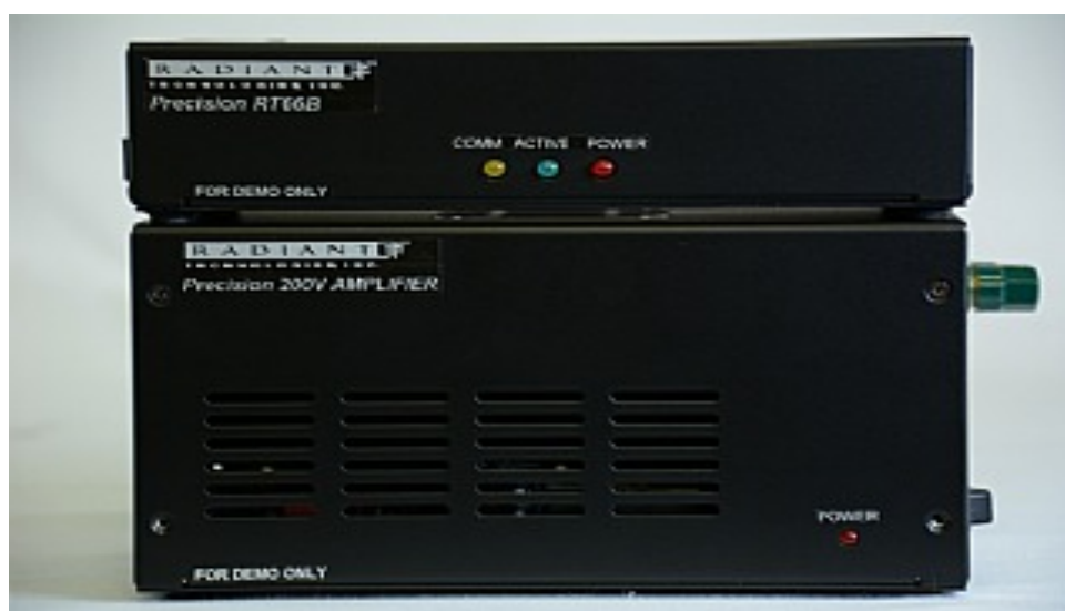
Figura 12- Equipamento Radiant Technology RT 6000 A utilizado para determinação da vida útil em fadiga dos filmes.
