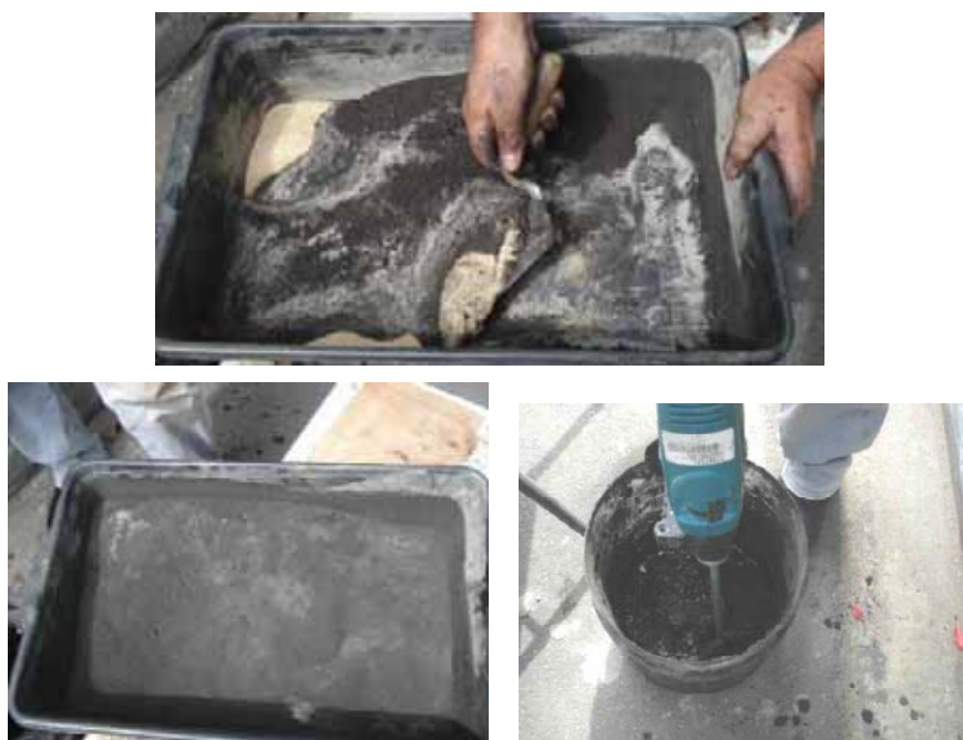
Figura 12 - Mistura das matérias-primas: preparação da pasta de cimento.
