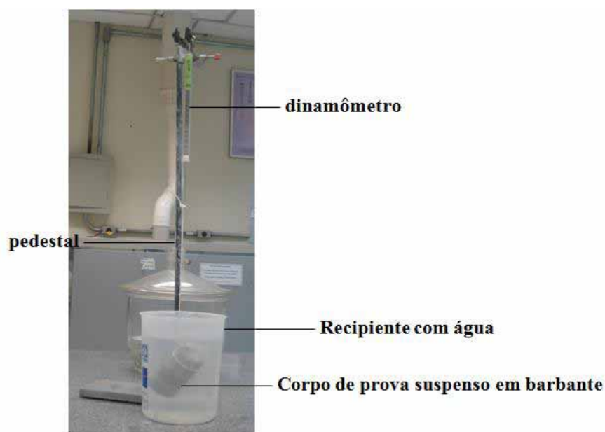
Figura 16 – Esquema da balança hidrostática para determinação da massa saturada dos corpos de prova.
