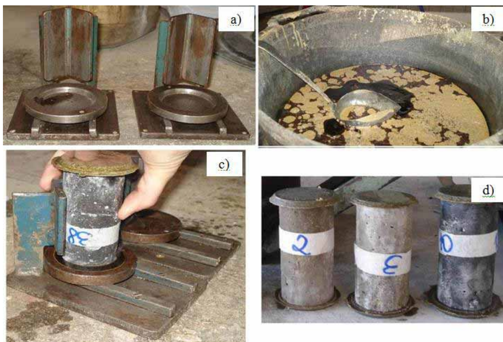
Figura 13 - Capeamento dos corpos de prova: a) suportes metálicos para capear; b) enxofre fundente; c) capeamento; d) corpos de prova capeados.
