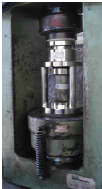
Figura 14 – Ensaio de compressão em prensa hidráulica e dispositivo para corpos de prova de argamassa.
