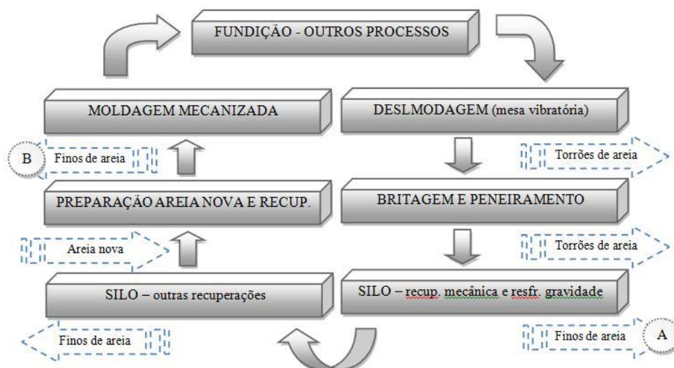
Figura 8 - Esquema do sistema de areia e pontos de coleta dos resíduos.
