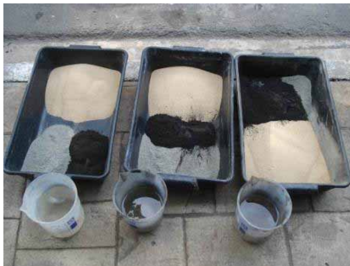
Figura 11 - Separação dos materiais pesados.
