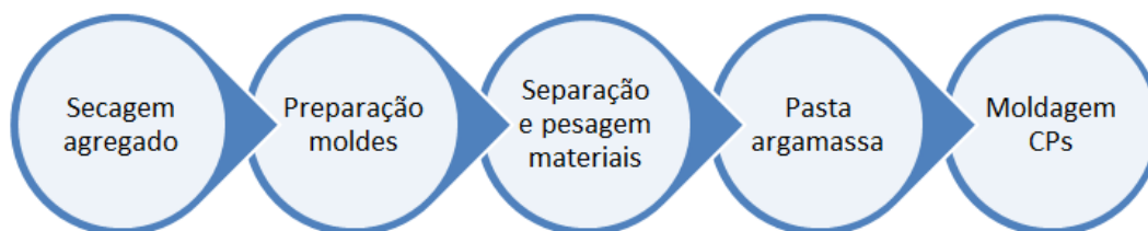
Figura 10 – Etapas para confecção dos corpos de prova
