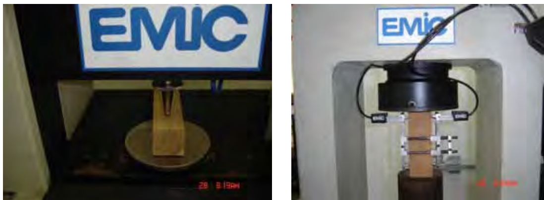
Figura 22 - Aspectos gerais do ensaio de dureza Janka normal às fibras (esquerda) e do ensaio de compressão paralela às fibras (direita)
