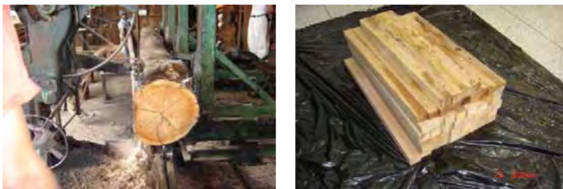
Figura 20 - Desdobro da tora em vigas e estoque de caibros de (6 \times 6 \times 120) \text{ cm}^3
