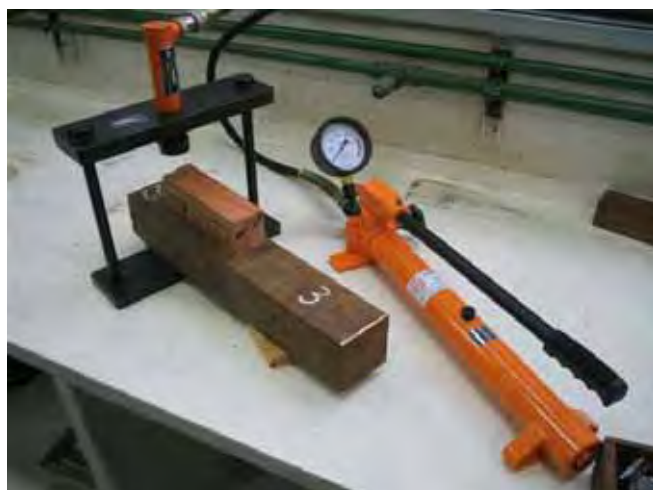
Figura 15 - Durômetro Janka - IPT
