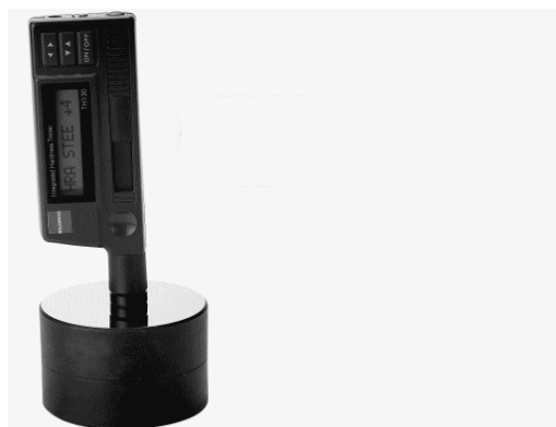
Figura 14 - Durômetro portátil com leitura eletrônica digital – Modelo TH130 – Integrated Hardness Tester .
