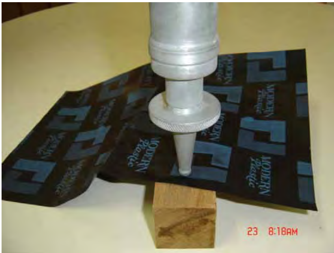
Figura 25 - Esquema geral de endentação da ponteira na madeira, com a utilização de carbono para ressaltar o contorno da calota esférica endentada.
