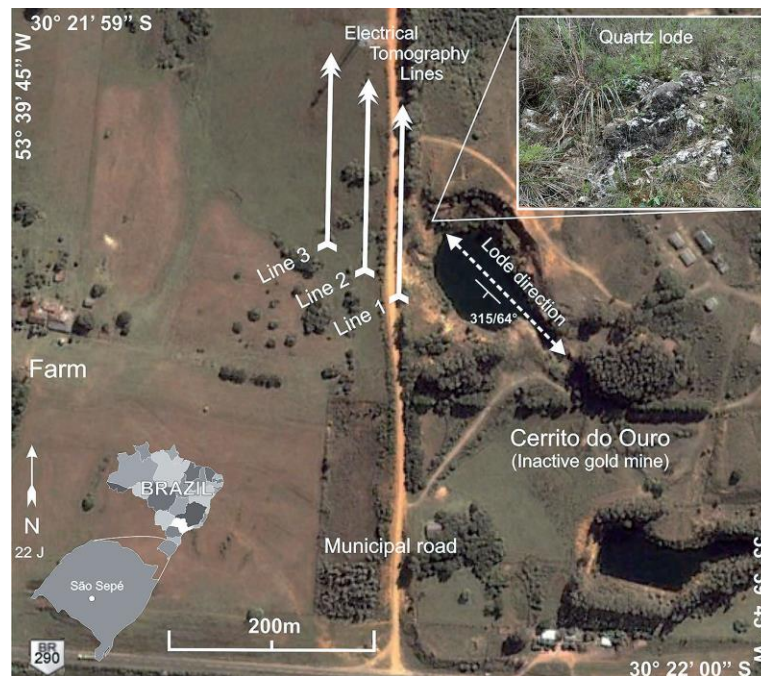
Figura 2.32 – Localização da ocorrência na mina do Cerrito do Ouro, com disposição das linhas de tomografia elétrica (Moreira et al. 2016).
