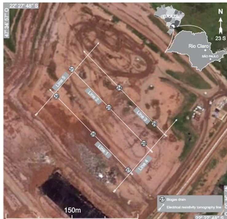
Figura 2.18 – Localização das linhas de tomografia elétrica em aterro sanitário, com posicionamento dos drenos de medida de biogás (Moreira et al. 2014).
