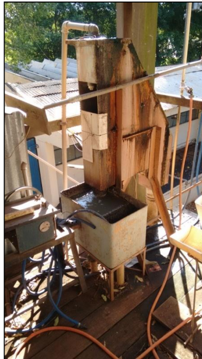
Figura 16- Peneira estática com abertura de 0,5 mm
