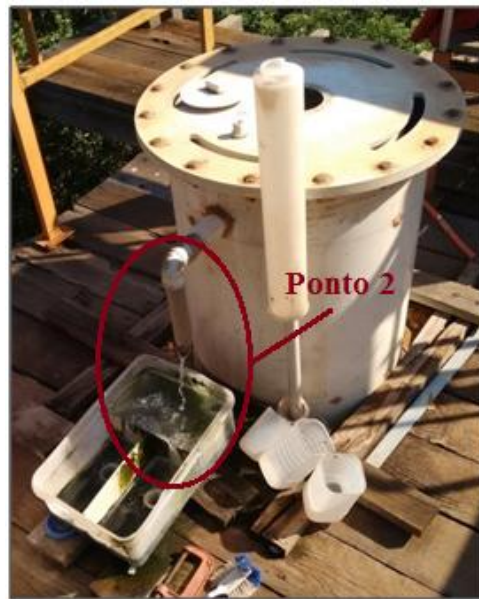
Figura 19- Parte superior do RUC, local onde foi coletado o efluente denominado Ponto 2
