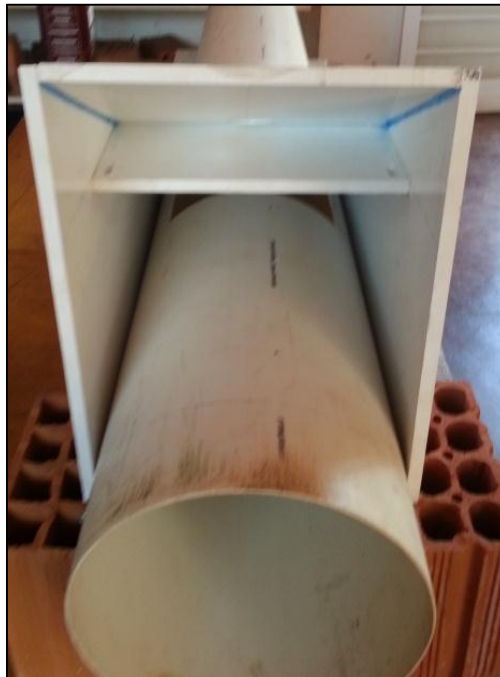
Figura 12- Unidade de sedimentação
