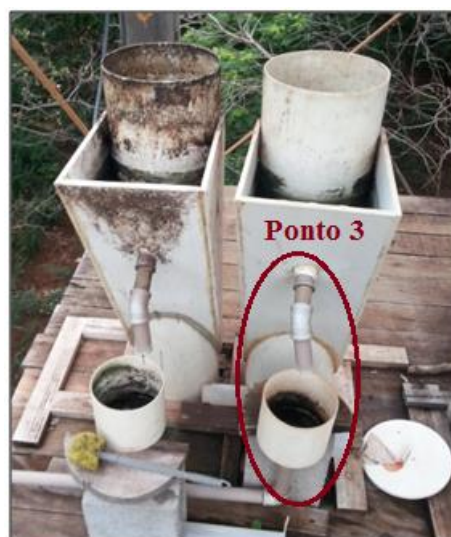
Figura 20- Vista superior do RALFC, local onde foi coletado o efluente denominado Ponto 3
