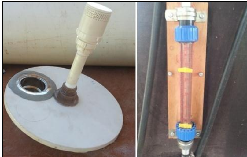
Figura 13- Fundo do RALFC com difusor de ar e rotômetro com capacidade de 1000 L/h
