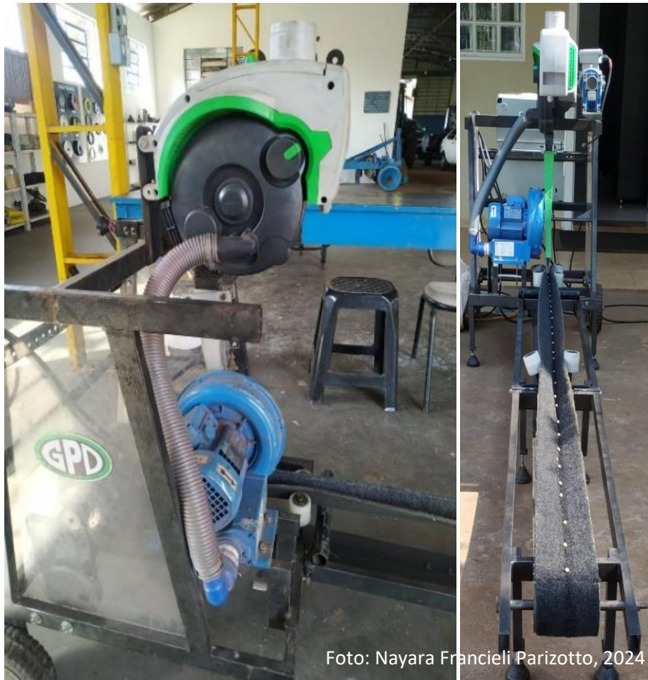
Figura 1 - Simulador de bancada para o sistema de mecanismo dosador pneumático– Selenium, as sementes são individualizadas no disco dosador através da pressão negativa.
