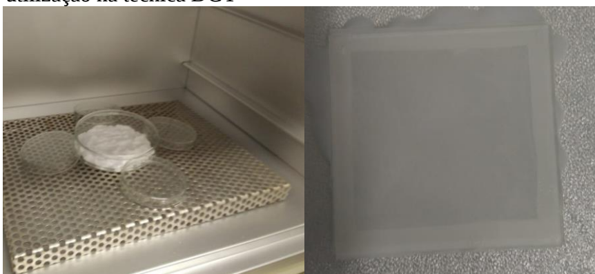
Figura 1 Procedimento de síntese (a) e imobilização (b) do Zr para utilização na técnica DGT
