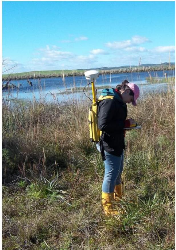
Figura 9 – Sistema de aquisição de dados com o GPS Pathfinder Pro-XR (adaptado de TRIMBLE, 2001).
