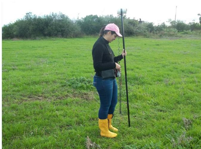
Foto 4 – Aquisições com o magnetômetro móvel (*Rover*) (Fonte: o autor).
