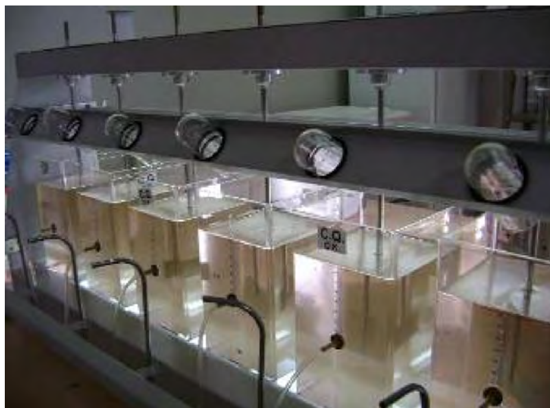
Figura 13: Dosagem simultânea das amostras
