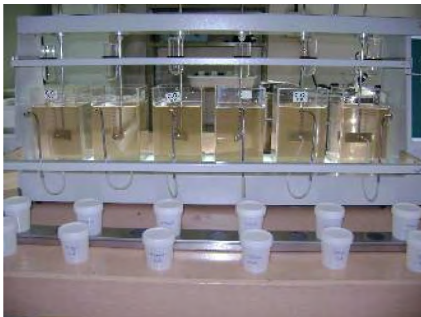
Figura 12: Homogeneização das amostras
