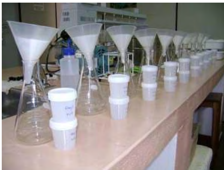
Figura 15: Sistema de filtração
