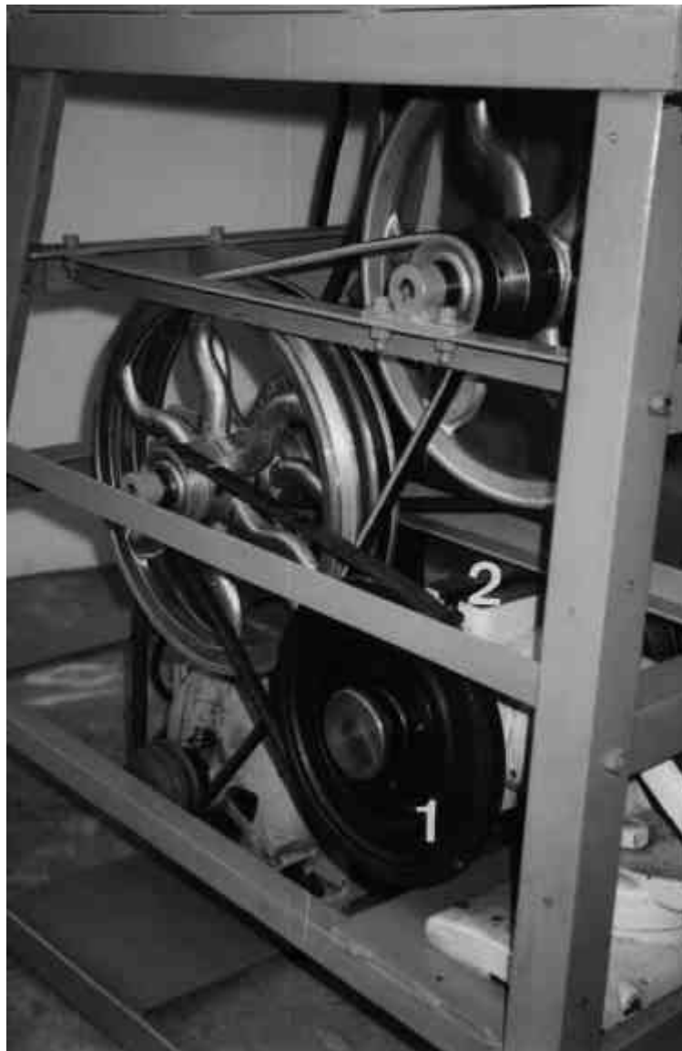
Figura 5.5: Detalhe da polia do cabeçote e transmissão.
