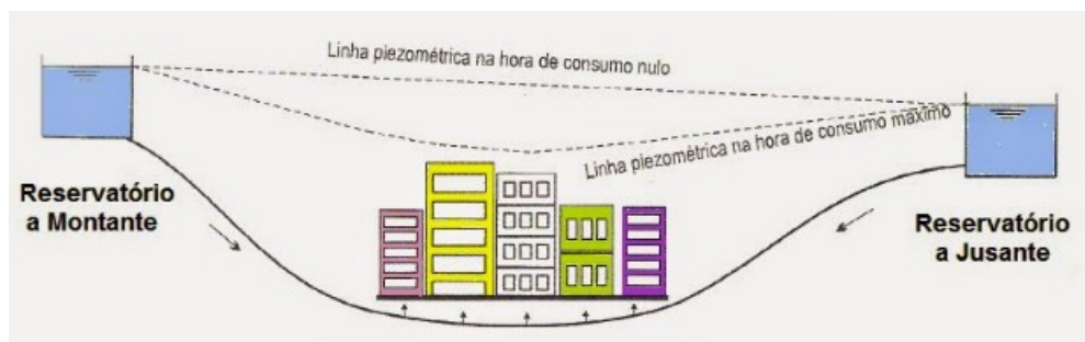
Figura 3.3 – Reservatórios de montante e de jusante.
