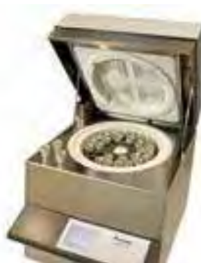
Figura 12. Equipamento prepASH utilizado na determinação de umidade e cinzas para as amostras de bagaço de cana com sacarose .
