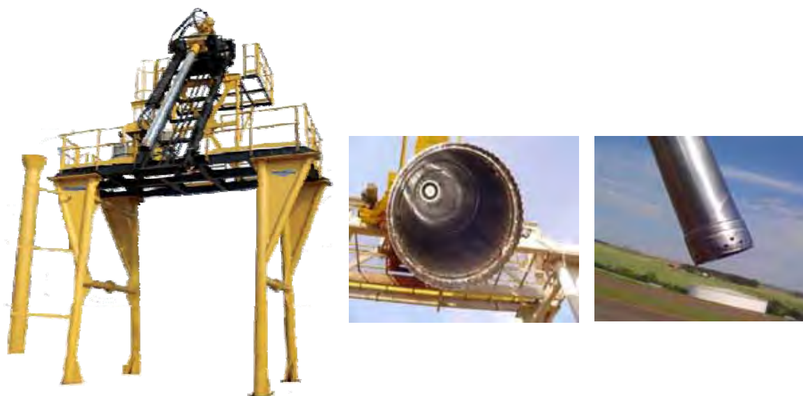
Figura 10. Sonda horizontal utilizada para amostragem de cana-de-açúcar e fotografias do canhão amostrador tiradas na Usina Santa Cruz.
