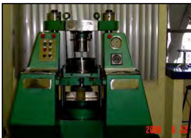
Figura 13. Fotografia da prensa hidráulica existente na Associação dos Fornecedores de Cana de Araraquara, utilizada para a prensagem das amostras de bagaço.
