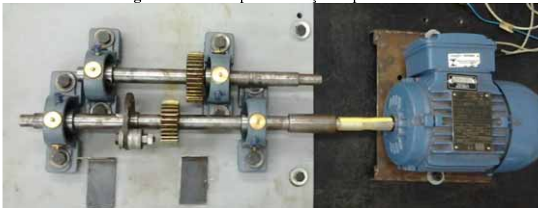
Figura 32 - Rotor para validação experimental
