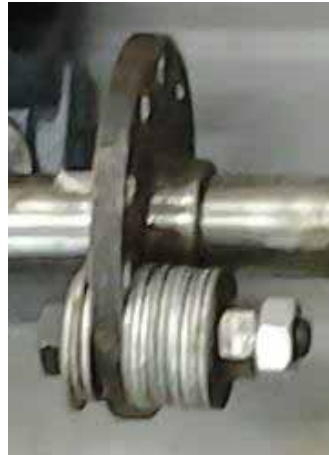
Figura 38 - Adicionamento de massa no disco
