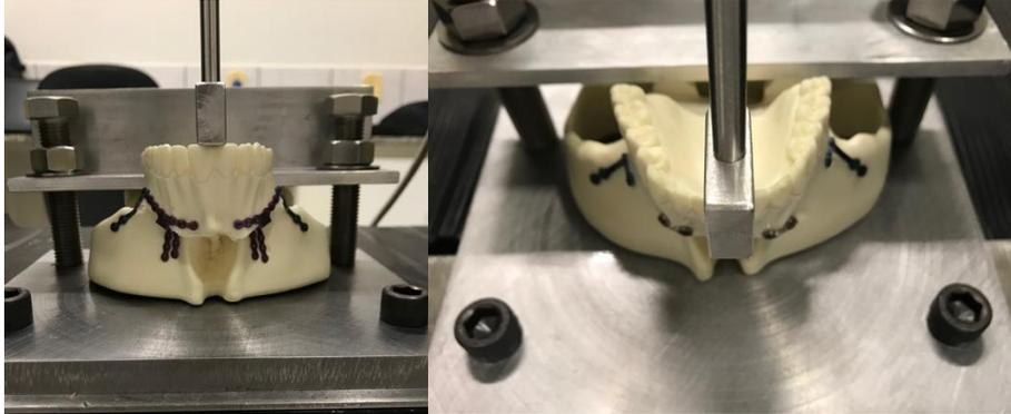
Figura 10: Suporte metálico: a) vista frontal - base horizontal com 20cm e com dois parafusos posteriores e uma cantoneira fixando o modelo b) vista axial – com dois parafusos anteriores fixando a base horizontal à máquina de teste com dispositivo retangular na região central dos incisivos centrais superiores.
