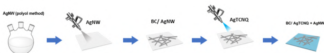
Figura 16 - Formação dos filmes híbridos de AgNW e AgTCNQ
