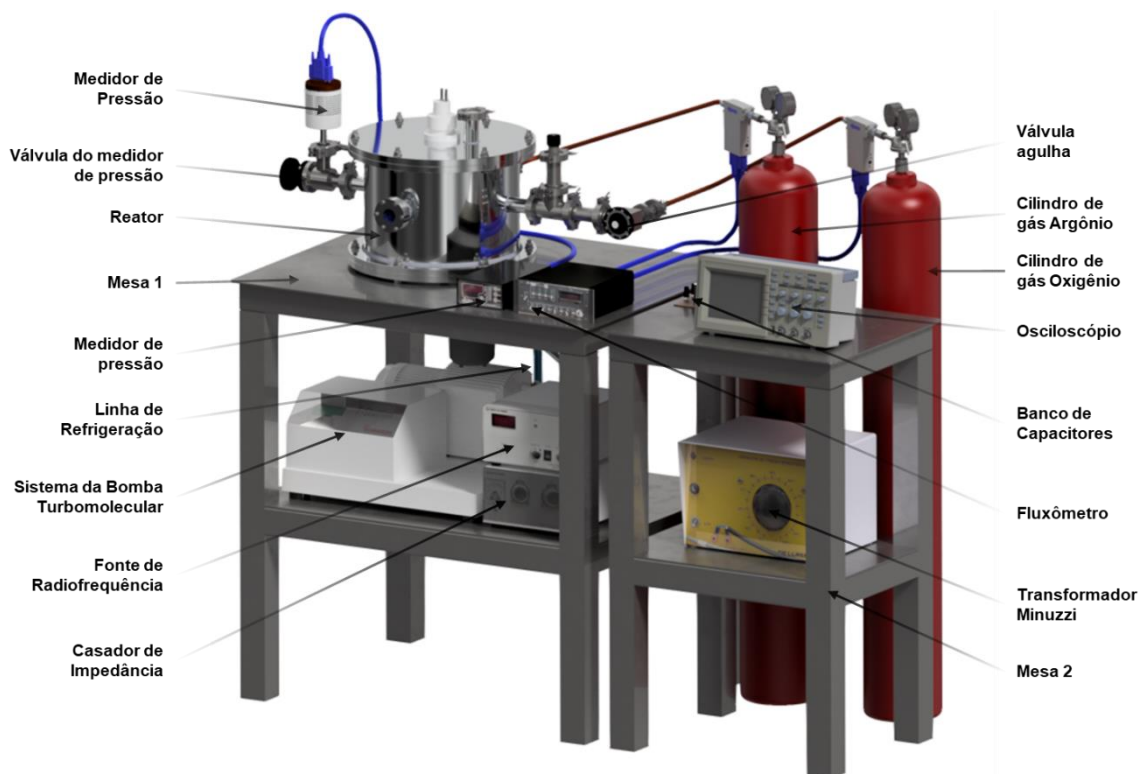
Figura 12 – Desenho Esquemático do Sistema de Magnetron Sputtering
