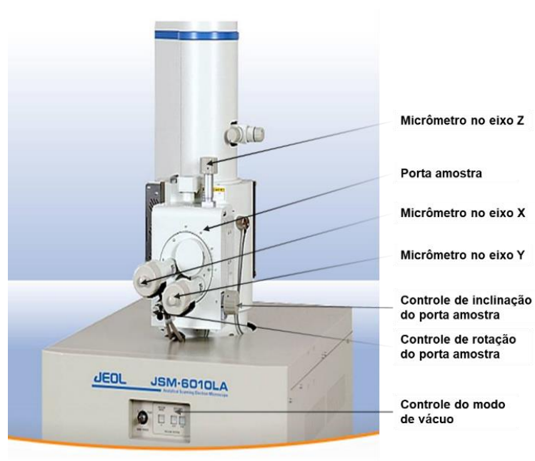
Figura 18 – Microscópio eletrônico de varredura JEOL JSM-6010LA
