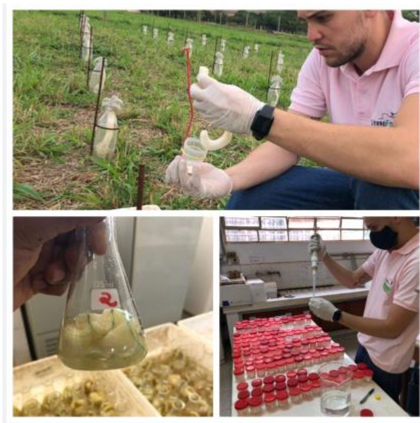
Figura 10. A - Extração de \text{NH}_3 volatilizada a campo; B - Espuma contendo a amônia volatilizada e \text{H}_2\text{SO}_4 ; C – Preparo das amostras, utilizando solução de \text{H}_2\text{SO}_4 -0,01 M.
