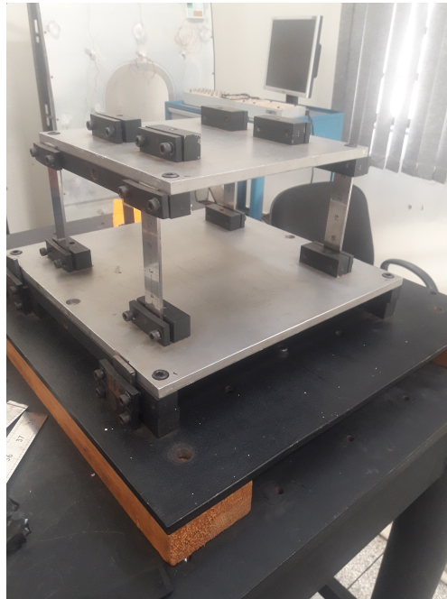
Figura 58 – Montagem experimental da mesa intermediária
