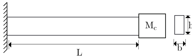
Figura 11 – Modelo de um absorvedor dinâmico do tipo lâmina vibrante
