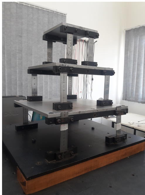
Figura 55 – Montagem experimental da estrutura primária
