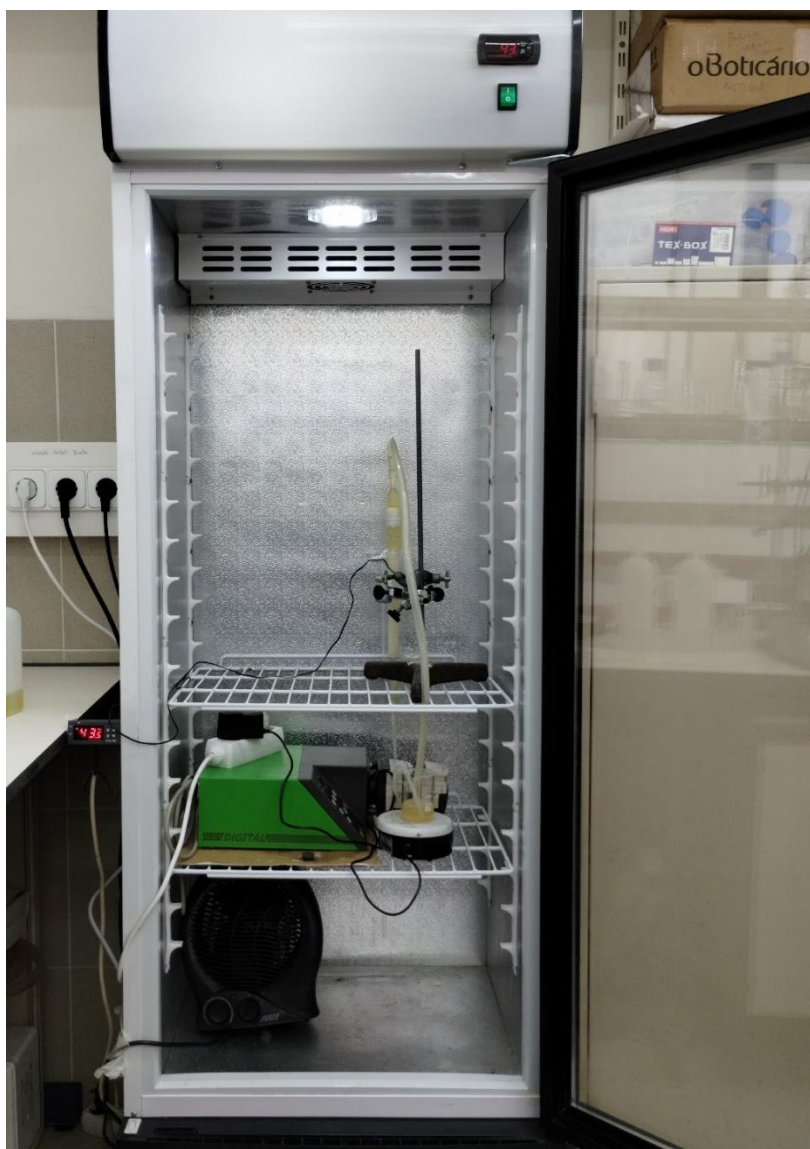
Figura 7.1 - Sistema de reator de leito fluidizado operando com reciclo na síntese de lipídios estruturados do tipo MLM em câmara de temperatura controlada
