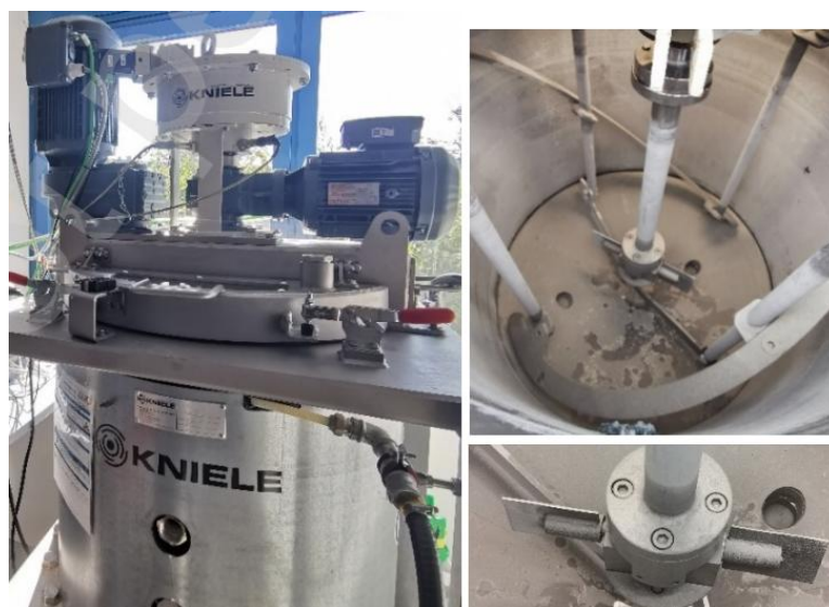
Figura 26: Misturador multi-eixos desenvolvido com a empresa Kniele GmbH
