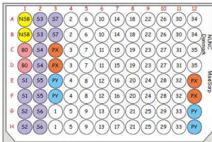
FIGURA 2: Ordem de pipetagem das soluções em placa de poliestireno contendo 96 poços, para realização de EIA. (NSB – Ligação não-específica, apenas a solução de ensaio; BO – Ausencia de Ligação, solução de ensaio e solução de ligação. S1 a S7 – Curva padrão, padrões para cada ensaio; Px – Controle de baixa concentração; Py – Controle de alta concentração; 1 a 35 – Amostras. (Fonte: Möstl & Palme, 2008)
