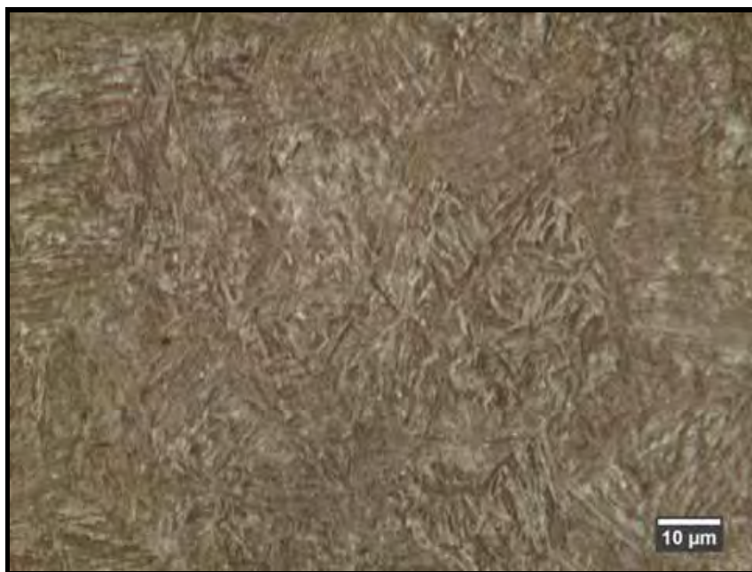
Figura 4.18. Ataque com reagente LePera. Ampliação 1000x. Condição 8 (850 °C / 286 °C / 1800 s).
