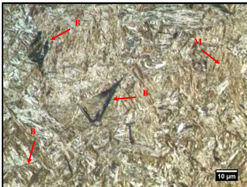
Figura 4.1. Ataque com nital 2%. Ampliação 1000x. Condição 1 (850 °C / 336 °C / 60 s). B (bainita), M (martensita).
