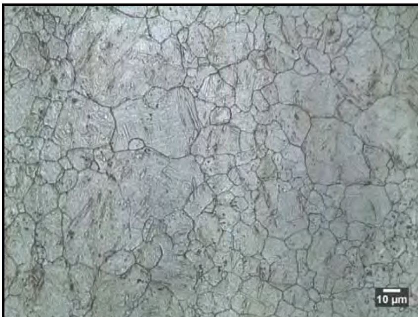
Figura 4.25. Ataque Contorno de Grão Austenítico. Ampliação 500x. Condição 5 (850 °C / 286 °C / 60 s).
