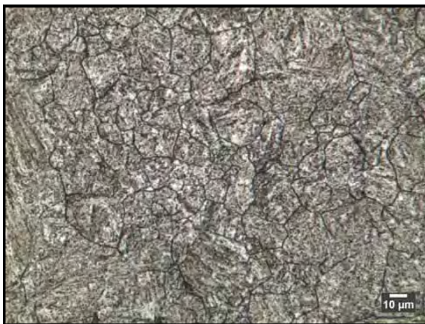
Figura 4.34. Pré-ataque com reagente Contorno de Grão e posterior ataque com reagente nital 2%. Ampliação 1000x. Condição 4 (850 °C / 336 °C / 1800 s).
