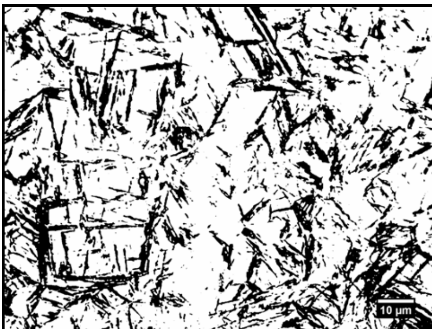
Figura 4.48. Imagem binária utilizada pelo software Image J para a quantificação da fração volumétrica. Imagem resultante da segmentação da fase bainita (área escura) e constituinte MA (regiões brancas) de uma fotomicrografia na condição 6 de tratamento térmico, obtida por meio de ataque químico com nital 2%.
