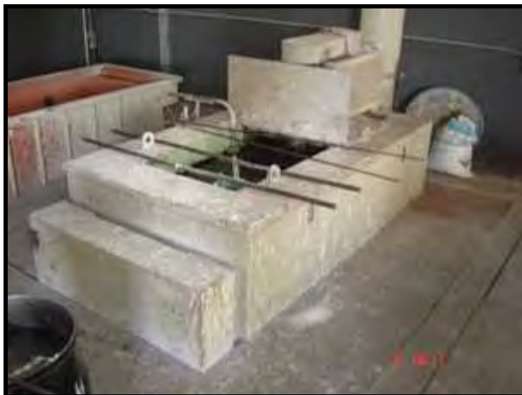
Figura 3.6. Forno banho de sal utilizado nos tratamentos isotérmicos à 286 °C e 336 °C.
