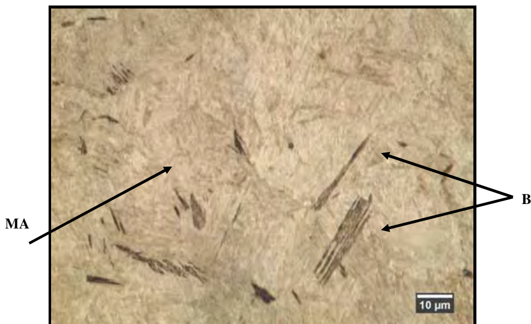
Figura 4.11. Ataque com reagente LePera. Ampliação 1000x. Condição 1 (850 °C / 336 °C / 60 s). B (bainita), MA (constituente martensita e austenita retida).
