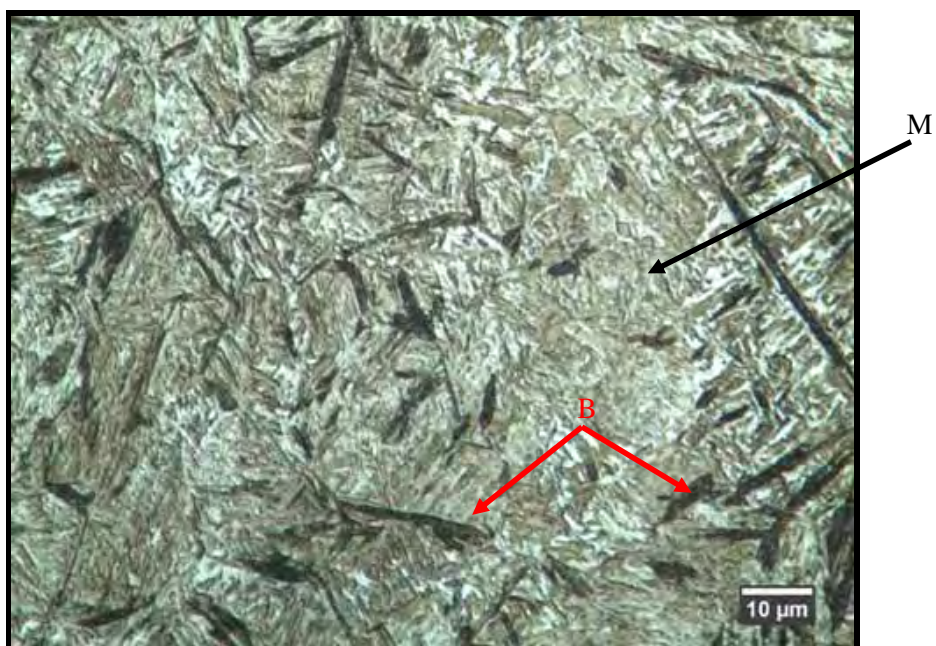
Figura 4.5. Ataque com nital 2%. Ampliação 1000x. Condição 5 (850 °C / 286 °C / 60 s). B (bainita), M (martensita).
