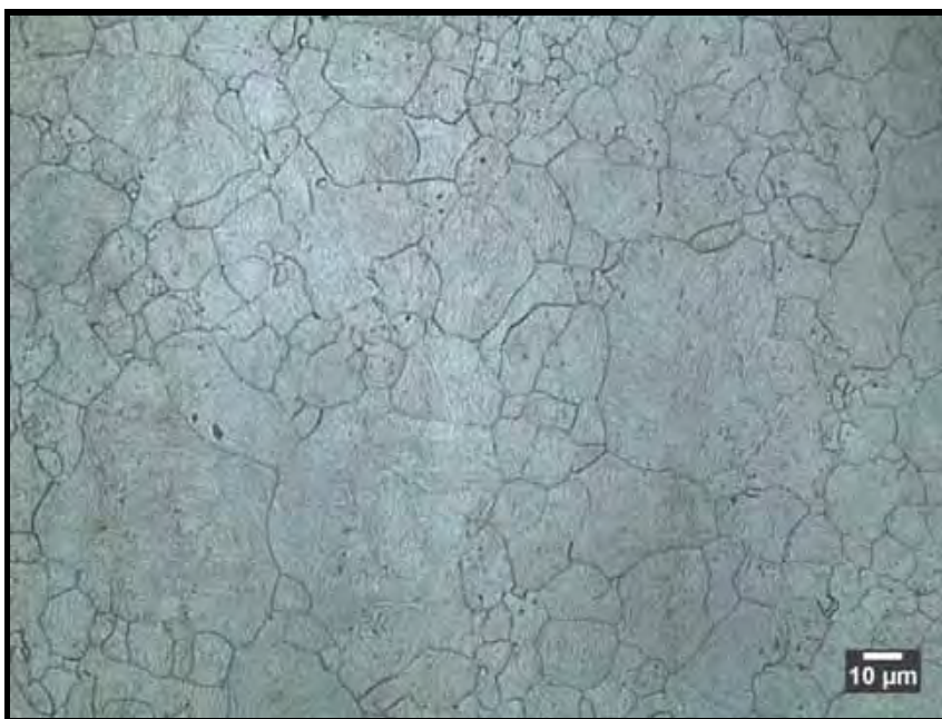
Figura 4.27. Ataque Contorno de Grão Austenítico. Ampliação 500x. Condição 7 (850 °C / 286 °C / 300 s).
