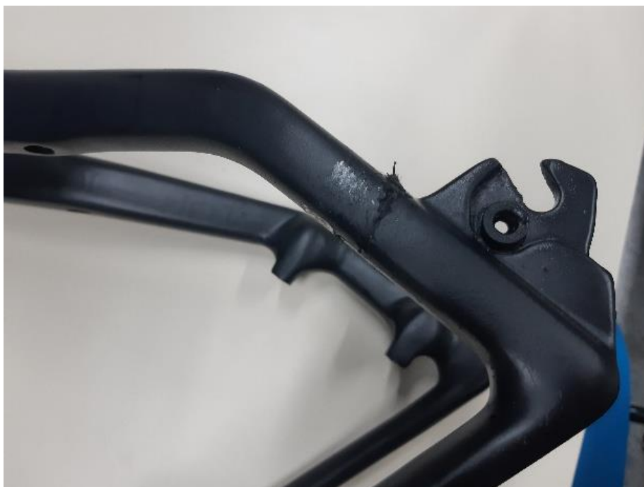
Figura 12 - Quadro de Carbono com a Trinca.
