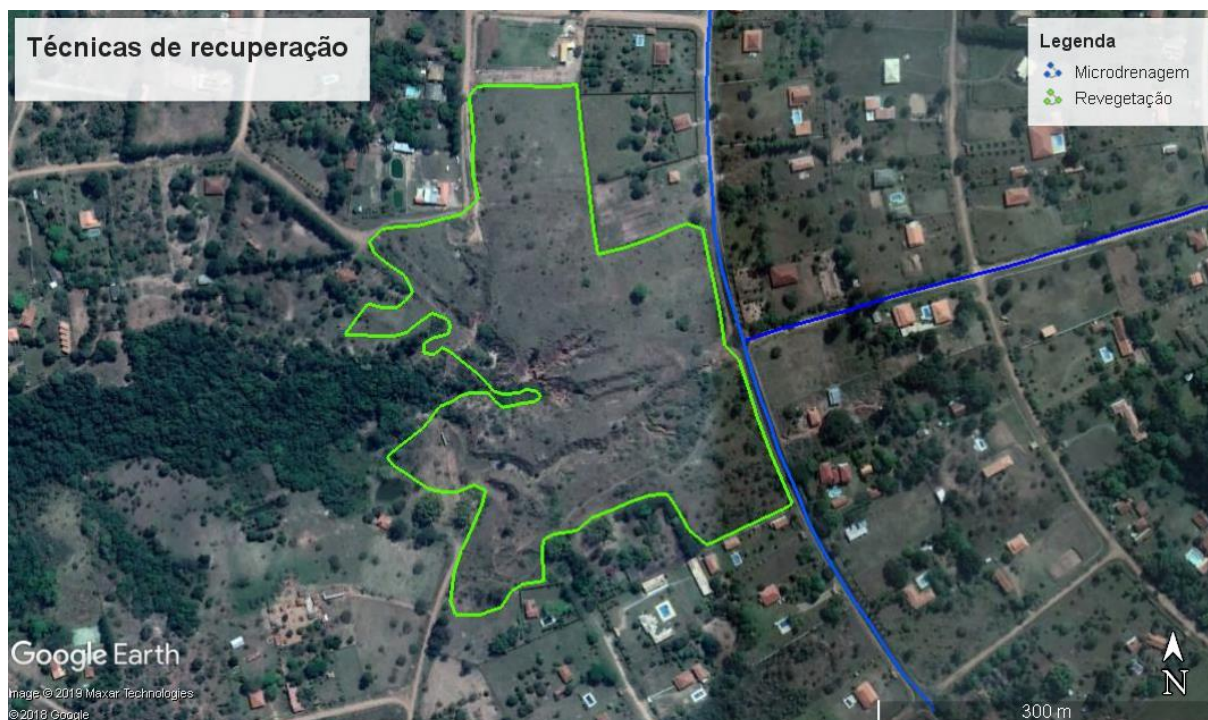
Figura 40 - Técnicas de recuperação adotadas para a área degradada.
