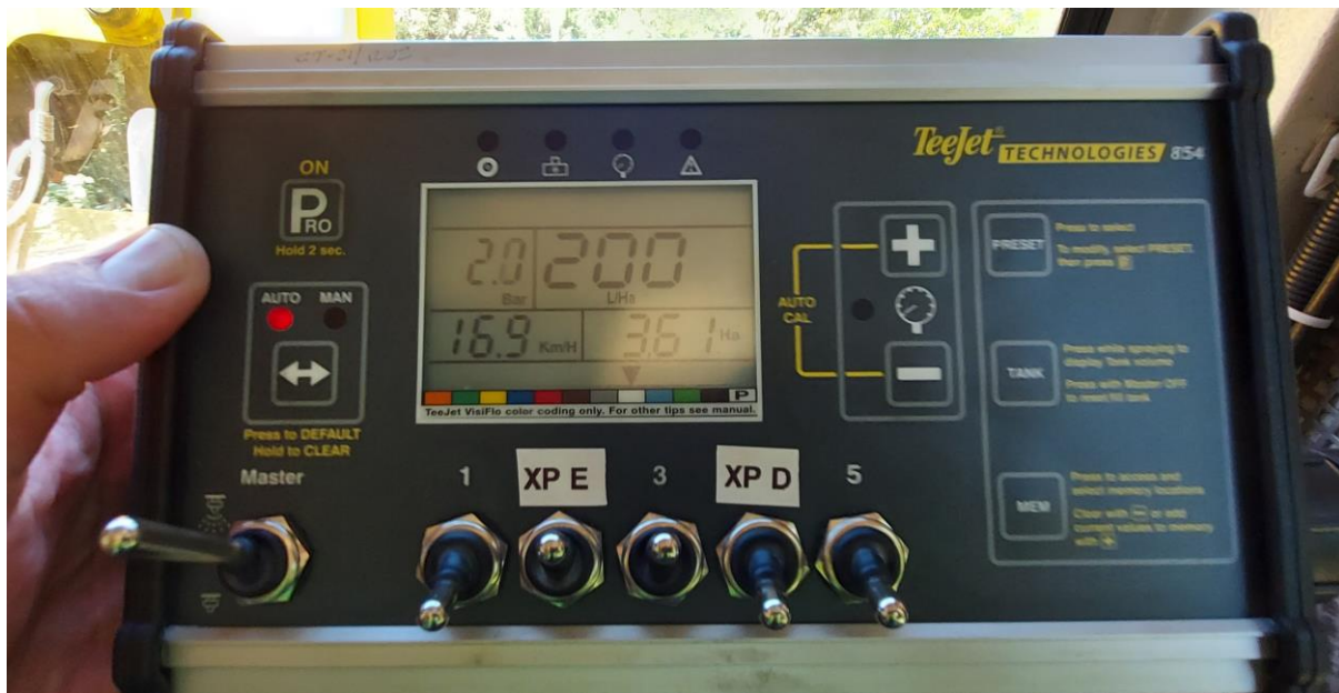
Figura 7. Controlador de teejet 854 durante a aplicação (Botucatu, 2021)
