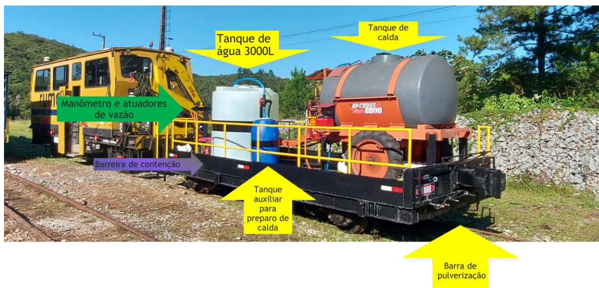
Figura 6. ilustração de composição e principais componentes desenvolvidos pelas equipes Rumo / Unesp (Botucatu, 2021)
