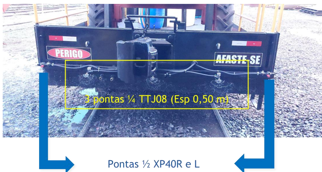
Figura 3. Disposição de pontas de aplicação com largura efetiva total de 6 metros (Rio Claro, 2021).
