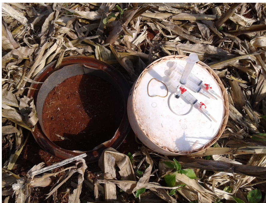
Figura 3. Detalhe da câmara de coleta de gases do efeito estufa no campo.
