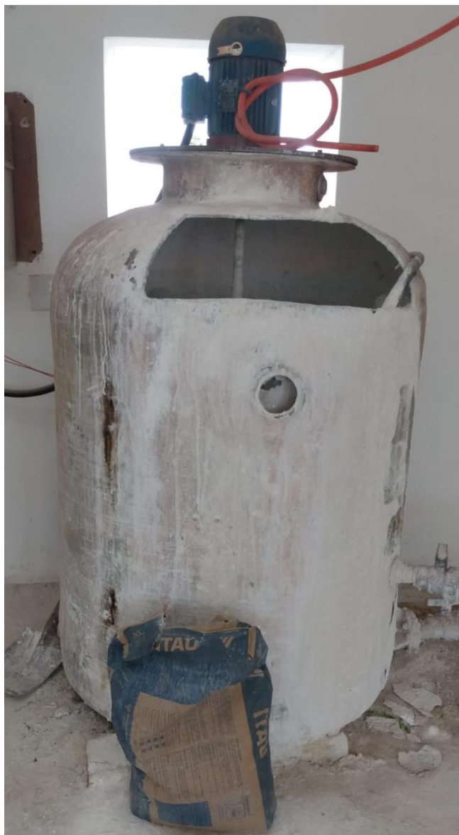
Figura 11 – Tina de preparação da solução de cal
