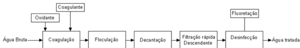
Figura 03 – Fluxograma do tratamento de água convencional
