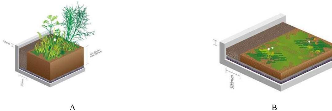
Figura 5 - Tipos de Telhado verde. A) ilustração de cultura intensiva; B) ilustração de cultura extensiva.
